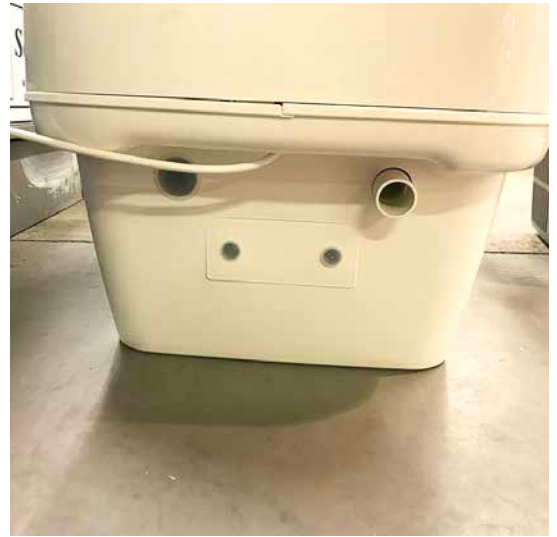
Det 32 mm breda röret för urin som mynnar ut på baksidan av Separett Villa kan vid rätt placering ledas rakt ut genom en yttervägg.
